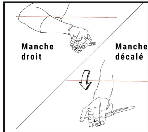
Le manche offset possède 2 anneaux désaxés ce qui optimise le positionnement du pouce pour la coupe. Le repose doigt directement forgé est également plus épais pour une meilleure prise en main.
