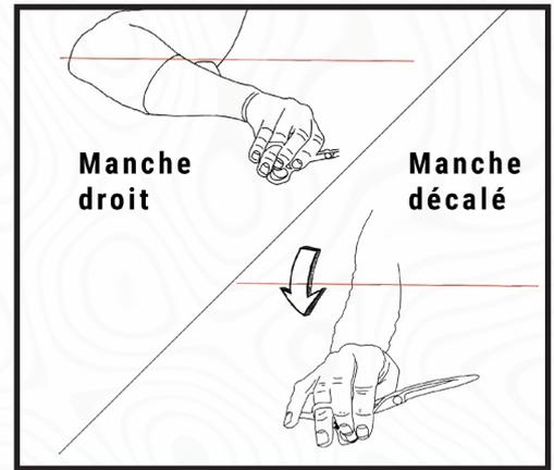
Le manche offset possède 2 anneaux désaxés ce qui optimise le positionnement du pouce pour la coupe. Ceci limite les risques de douleurs au canal carpien, et entraîne également une position plus confortable du bras.
