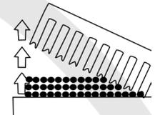
Système Reverse Blade avec les dents disposées à l'arrière de la lame droite
