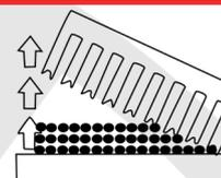
Système Reverse Blade avec les dents disposées à l'arrière de la lame droite
