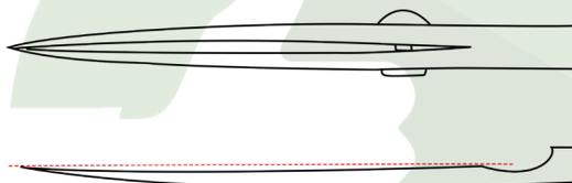
La lame en forme épée associée à la forme légèrement concave des ciseaux japonais (en forme de palourdes) renforce la puissance et la force de coupe des lames.
