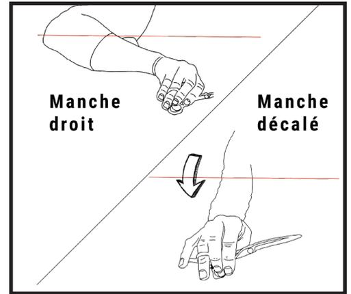
Le manche offset possède 2 anneaux désaxé ce qui optimise le positionnement du pouce pour la coupe. Ceci limite les risques de douleurs au canal carpien, et entraîne également une position plus confortable du bras.
